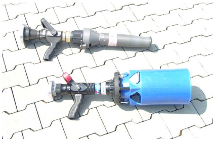
Bild 12: Hohlstrahlrohre mit Schaumaufsatz
