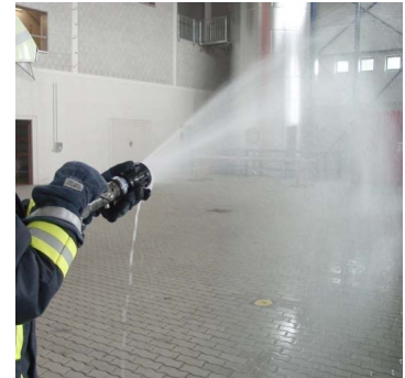
Bild 21: Unbefriedigendes Sprühbild bei 3 bar
